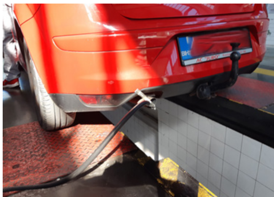
Slika 8. Mjerenje srednjeg stepena zacrnenja ispušnog plina kod automobila sa dizel motorom
