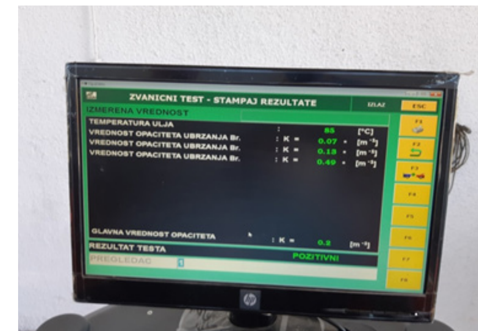
Slika 9. Rezultati testa mjerenja stepena zacrnenja ispušnog plina dizel motora na jednoj od stanica tehničkog pregleda u Kantonu Sarajevo
